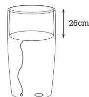
Avec bouchon pour lestage et tuyau d'évacuation d'eau
